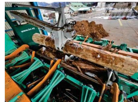
図2 大径材の根張加工機械
