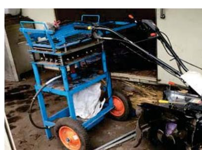
図3 コンテナ苗抜取機
