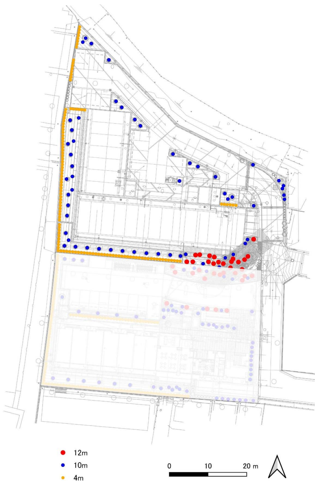
図. 管理上予定している将来樹高 (南側は認証取得地であるヒューリックガーデン津田沼)
